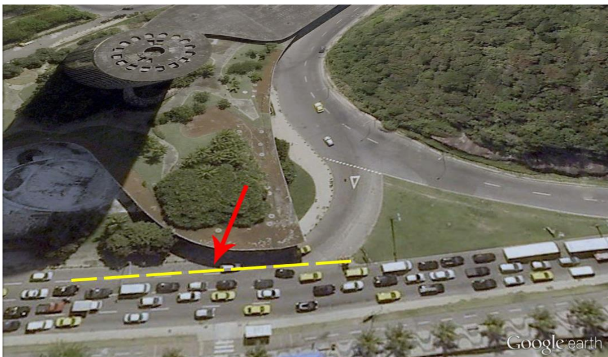
FOTO 6 - Tachões altos para demarcar os limites do fluxo à esquerda e do fluxo em frente
