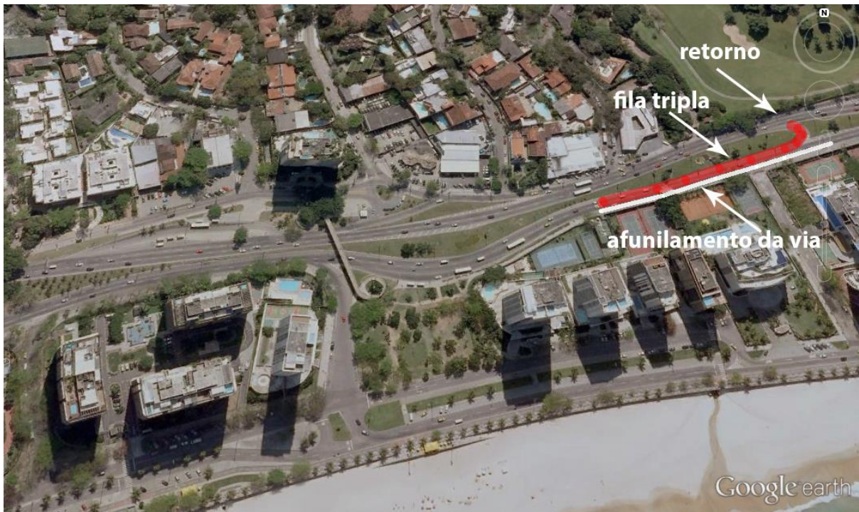
FOTO 8 - Filas duplas e triplas e afunilamento da Autoestrada
